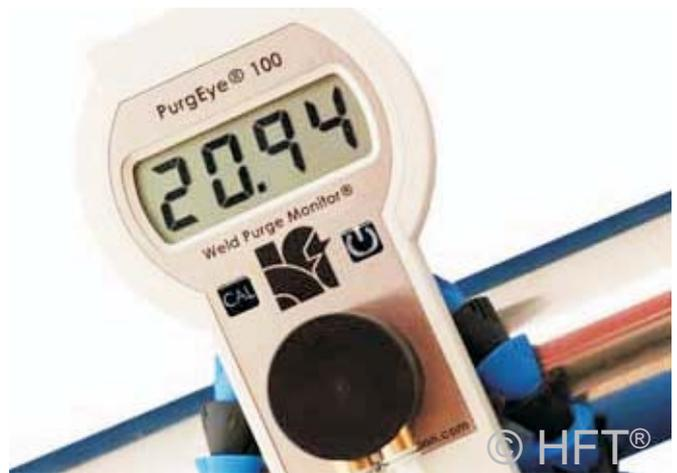
Antes de la soldadura se puede empezar a usar un gas inerte, es esencial saber que el contenido de oxígeno en la zona de soldadura se ha reducido a un nivel aceptablemente bajo.
